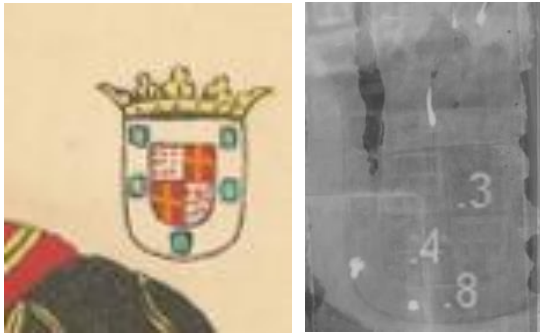
(esq.) Figura 56a _ Retrato de Nuno da Cunha, AMVG, pormenor da radiografia na zona do escudo subjacente, com a marcação dos pontos de EDXRF (NC3, NC4 e NC8). (inf.) Gráfico 5 _Espectro dos referidos pontos com o reporte dos elementos identificados. A presença de estanho complementa a análise por mapeamento 2D, sugerindo a utilização de pigmento amarelo de chumbo e estanho. Créditos: HERCULES, LJF/DGPC; (dir.) Figura 56b _Pormenor da reprodução do retrato de Nuno da Cunha por José Delorme Colaço (1841), confirmando no escudo as cores identificadas por EDXRF, indicando que terão sido mantidas ao longo do tempo, ou, aplicadas em repinte posterior, utilizando os mesmos pigmentos.
