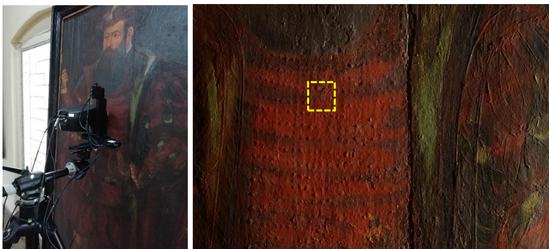
(esq.) Figura 42a _ Retrato de Jorge Cabral. Pormenor do equipamento de XRF ELIO durante o processo de análise. Créditos: Sara Valadas. (dir.) Figura 42b _ Pormenor de Fotografia de Luz Rasante da zona superior, identificando-se claramente as texturas subjacentes, com destaque (quadrado amarelo) da zona de mapeamento elemental 2D por XRF. Créditos: HERCULES; LJF/DGPC
