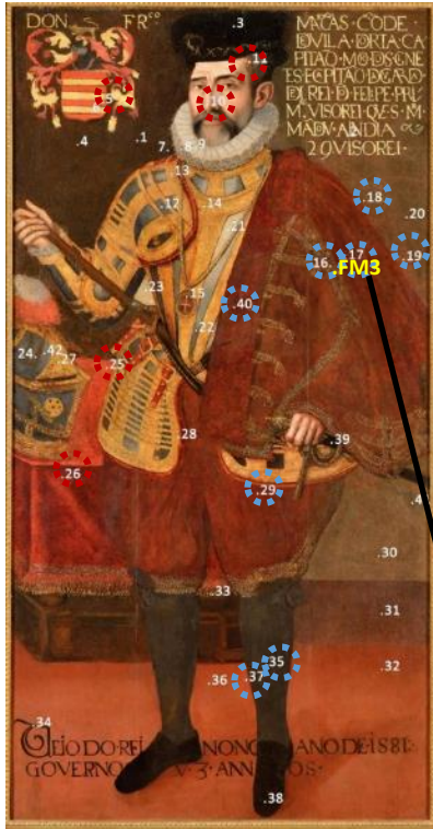
Figura 79_ Retrato de D. Francisco de Mascarenhas, com marcação das zonas de análise por EDXRF e onde foi reportado o elemento Hg (a vermelho) e o elemento Co (a azul). A amarelo é a zona de recolha da amostra FM3. Créditos: HERCULES, LJF/DGPC.
