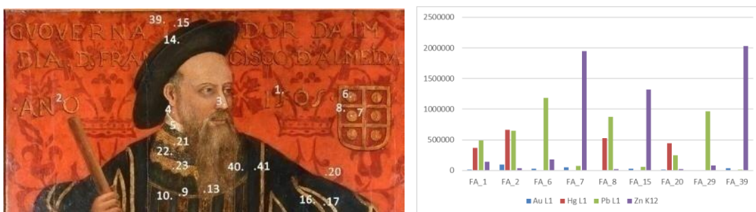
Figura 38 _ Retrato de D. Francisco de Almeida, MNA. Mapa de pontos XRF da zona superior. (dir.) Gráfico 2 _ Reporte dos elementos Ouro (Au), Mercúrio (Hg), Chumbo (Pb) e Zinco (Zn) no retrato de D. Francisco de Almeida. Créditos: HERCULES; LJF/DGPC
