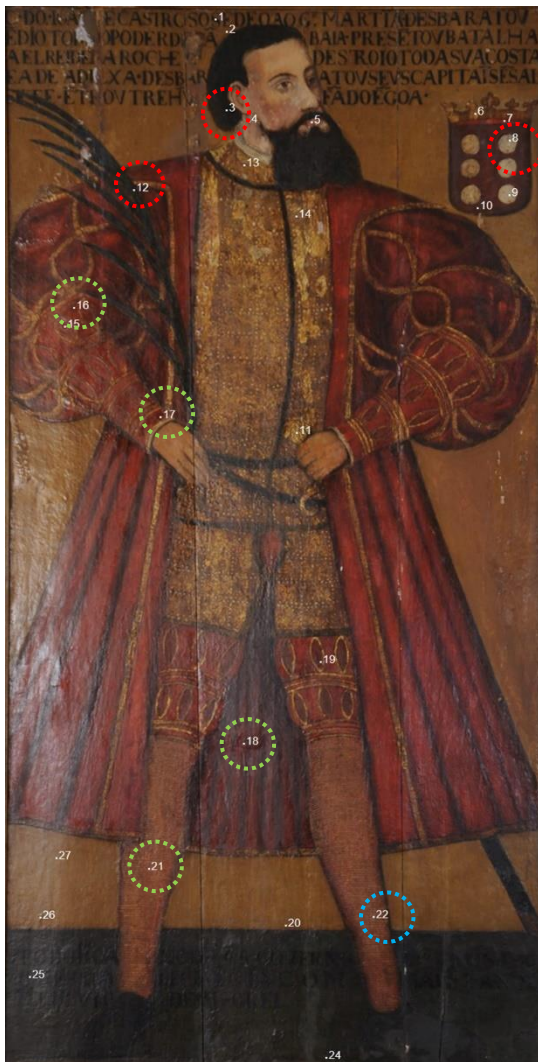
(esq.) Figura 40a _ Mapa de pontos EDXRF, retrato de D. João de Castro. Os círculos vermelhos indicam as zonas com reporte de Cobre (Cu), os círculos verdes as zonas com reporte de Mercúrio (Hg) e os círculos azuis as zonas com reporte de Zinco (Zn), de acordo com os resultados indicados no Gráf. 3. Créditos: HERCULES; LJF/DGPC. (dir.) Figura 40b _ Reprodução do retrato de D. João de Castro n' O Livro de Lisuarte de Abreu , c. 1560. Créditos: CNCDP
