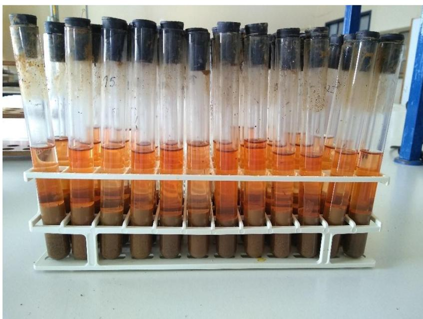
Figura 3.7 - Tubos de ensaio com amostra de solo e solução de TTC a 1%, após incubação.
