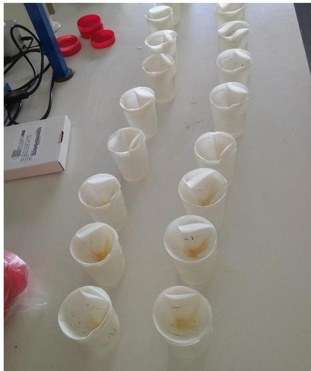
Figura 3.6 - Filtração do sobrenadante das sub-amostras de solo.
