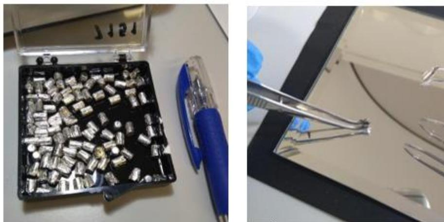
Figura 3.12 - Fotografia das cápsulas de estanho utilizadas.
