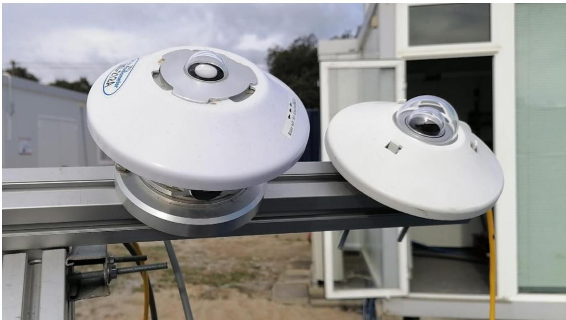
*Figura 17 - Equipamentos de monitorização da radiação solar. Piranómetro, à esquerda, e Radiómetro, à direita.*
