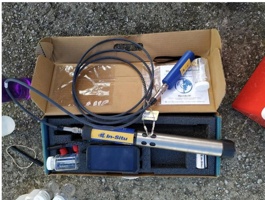
Figura 23 - Sonda multiparamétrica utilizada.
