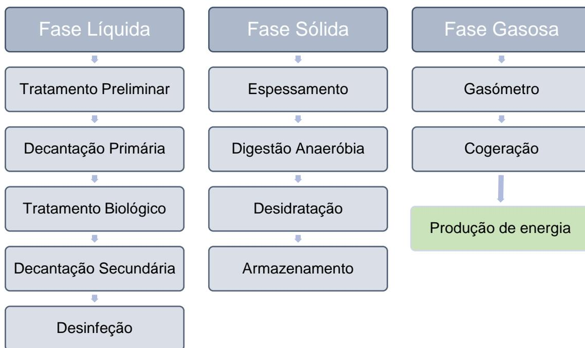
Figura 3 - Processo de tratamento na ETAR de Évora. (EPAL)
