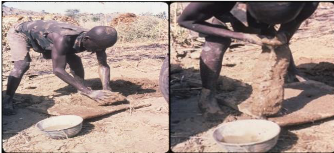
Figure 13: Préparation des colombins
