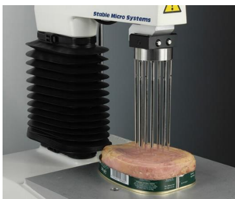
Figura 15: Sonda de penetração múltipla utilizada no ensaio. Fonte: https://robinaanugerah.com/stable-micro-systems-product/texture-analyzer/ .
