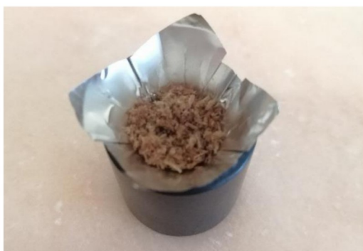
Figura 12: Copo de folha de estanho com 0,2g de amostra.
