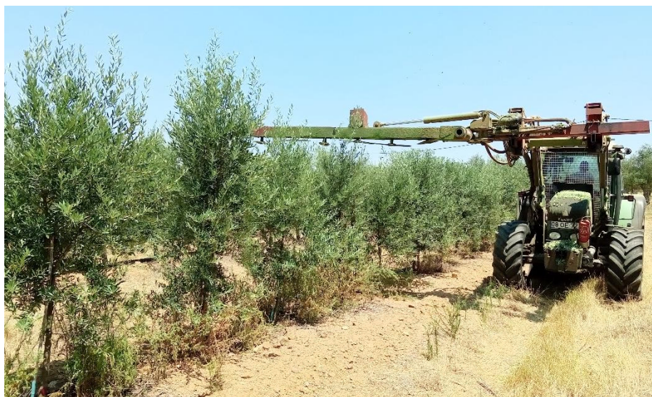
Figura 40: Corte realizado na parte superior da copa
