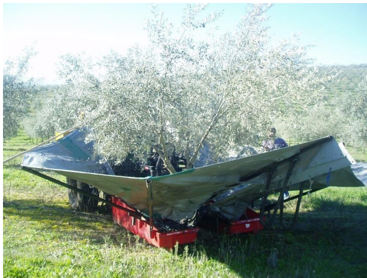
Figura 6 - Vibrador com apara-frutos
