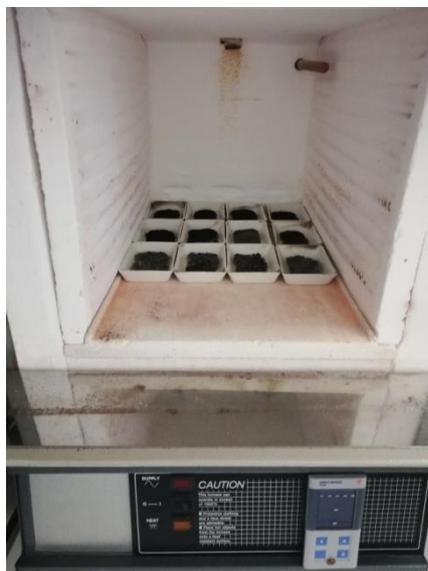
Figura 11 - Amostras compósitas na mufla (Fonte: Autor)
