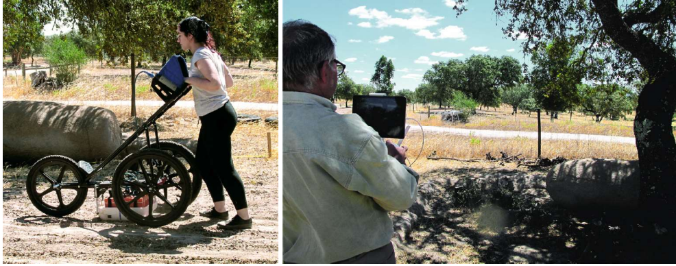
Fig. 7. Campanha de prospeção geofísica com georradar
