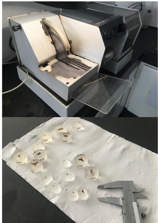
1. Interromper o processo regularmente, para verificação à lupa do progresso no desgaste do fóssil.
