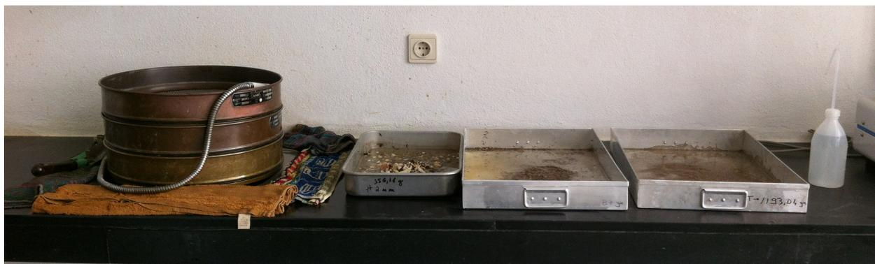
**FIGURA 4.1** Equipamento de lavagem e triagem de sedimentos (P. Fialho, 2016).
