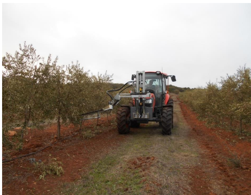
Figura 24 - Máquina de barra de corte de movimento alternativo as em olival em sebe (Fonte: A.Dias).
