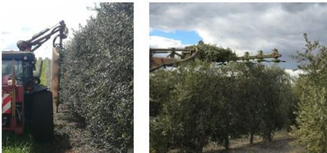
Figura 37 - Podadora de discos em corte vertical (lado esq.) e horizontal (lado dirt.)
