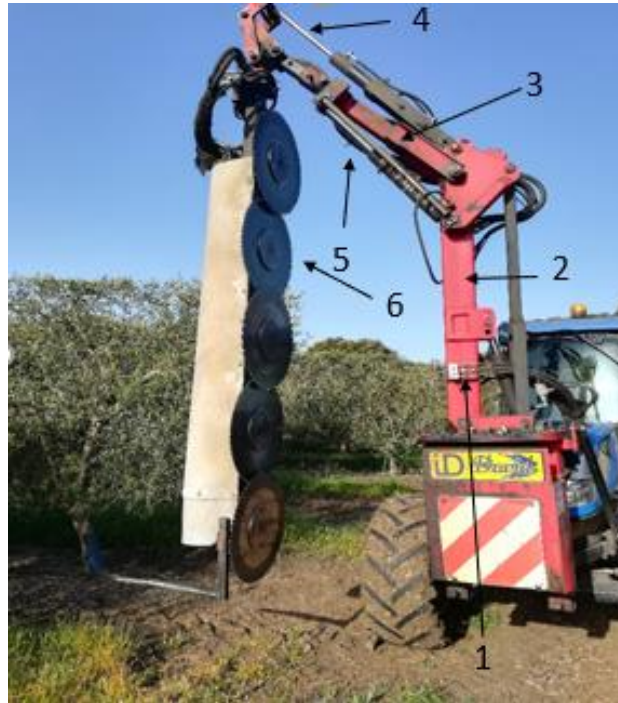
Legenda: 1- Estrutura de suporte; 2 – Coluna; 3 – Braço de elevação; 4- Cilindro hidráulico para regular posição barra de corte; 5 - Cilindro hidráulico para movimentar braço de elevação; 6- Discos de corte.
