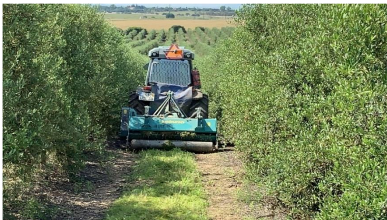
Figura 30 – Trator com máquina de destroçar erva montada no sistema de engate de três pontos do trator em trabalho.
