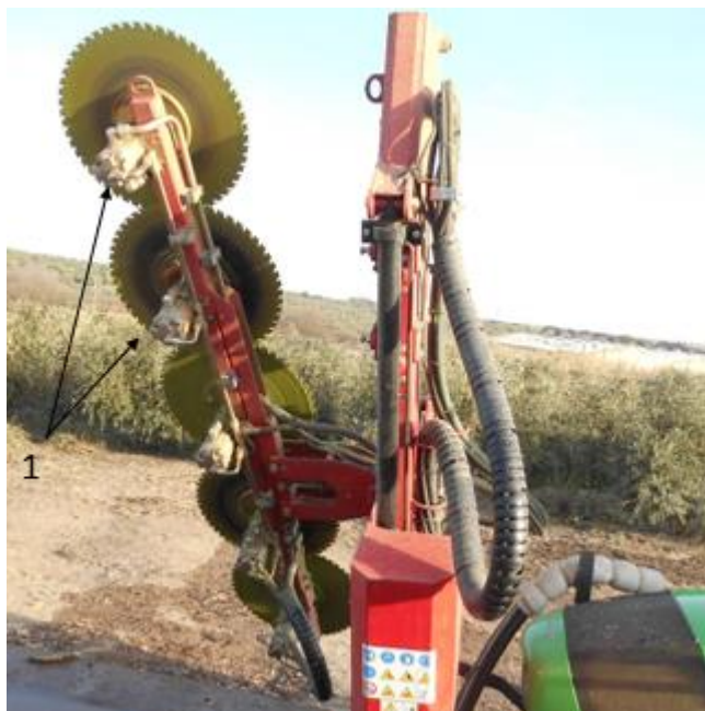
Legenda: 1 – Motores hidráulicos para os discos de corte. Figura 35 - Aspecto da fixação na frente do trator.
