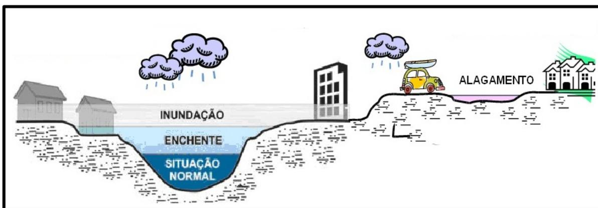
Figura 5.4 – Perfil esquemático do processo de cheias e inundações (IPT, 2004).
