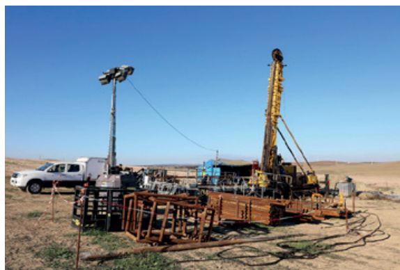
Figura 2 - Sondagem profunda, realizada em novembro de 2021, junto à povoação de Aljustrel, para prospeção de sulfuretos maciços na faixa pirítica ibérica. Fotografia de Luís Lopes.
