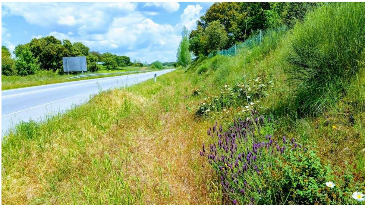
Figura 10 – Exemplo de demarcação entre os sectores proximal, onde domina a vegetação herbácea com altura baixa, e o distal onde se permite a instalação de arbustos em talude, em contexto de montado. (Foto: António Mira)
