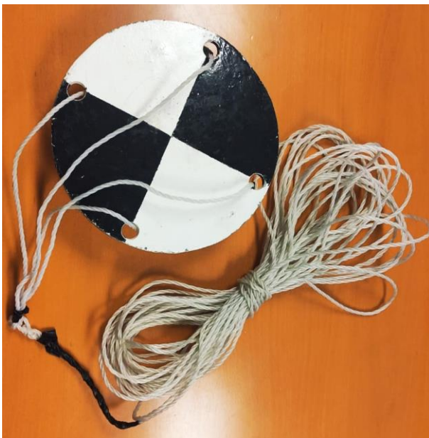
Figura 15- Disco de Secchi com diâmetro de 23cm e cabo branco de 20m, para avaliação da transparência da água nas pisciculturas.
