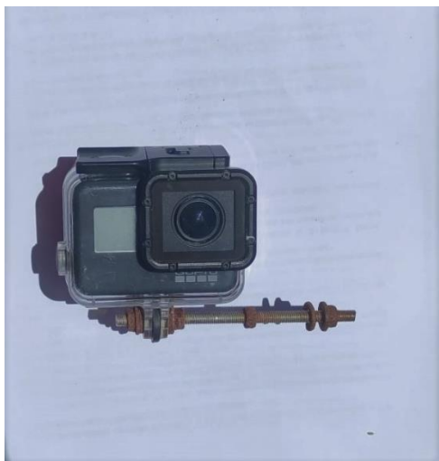
Figura 12- Câmara GoPro Hero 7 (1080 SuperView, 60/50fps, 1920x1080, 16:9) em caixa protetora, utilizada para filmagens subaquáticas
