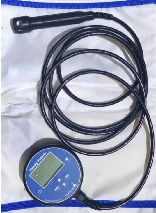
Figura 16 - Sonda Handy Polaris OxyGuard, Farum, Dinamarca, para avaliação da temperatura e oxigénio dissolvido da água nas pisciculturas.
