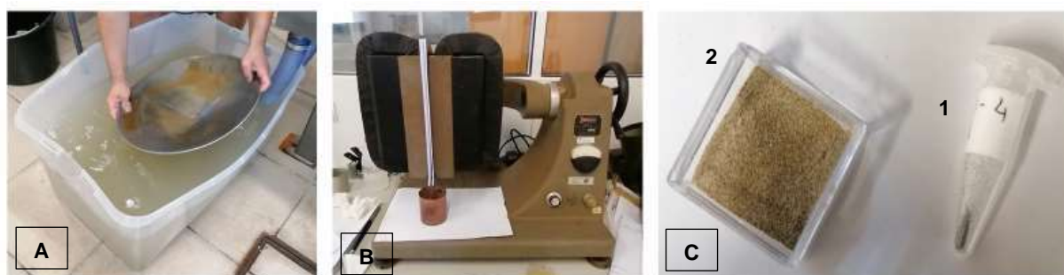
Figura 3.5. Procedimentos utilizados para a separação mineral: a) Bateamento das amostras; B) Separação magnética com recurso ao Frantz; C) Resultado obtido após o Frantz com a separação da fração magnética (1) da fração não magnética (2).
