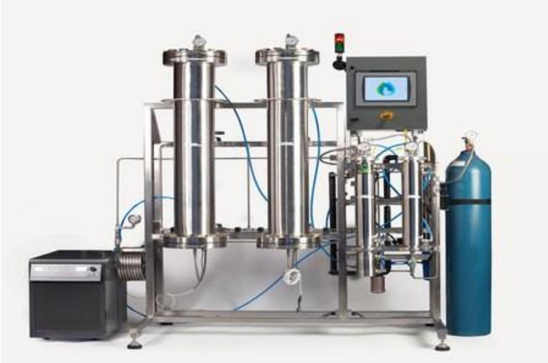
Figura 4: Equipamento de extração através de fluidos supercríticos. Adaptado de Sentryca Nutridermaceuticals®
