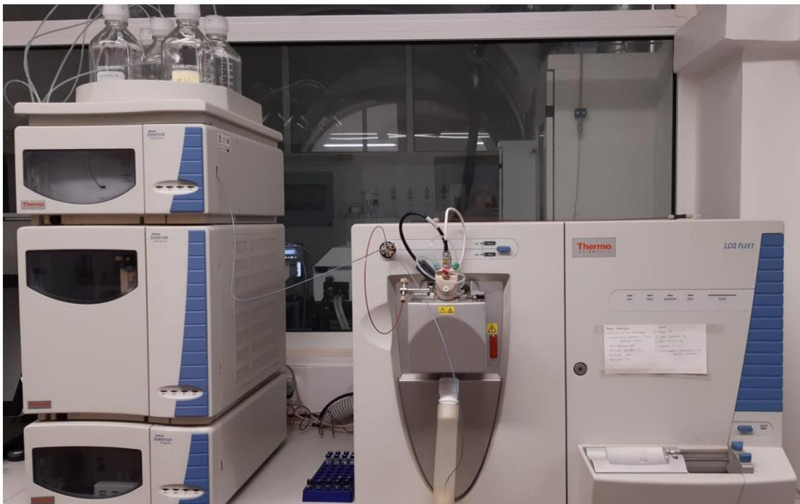
Figura 7: Sistema de cromatografia líquida acoplada a espectrometria de massa e detecção por diode array (LC–DAD-MS).
