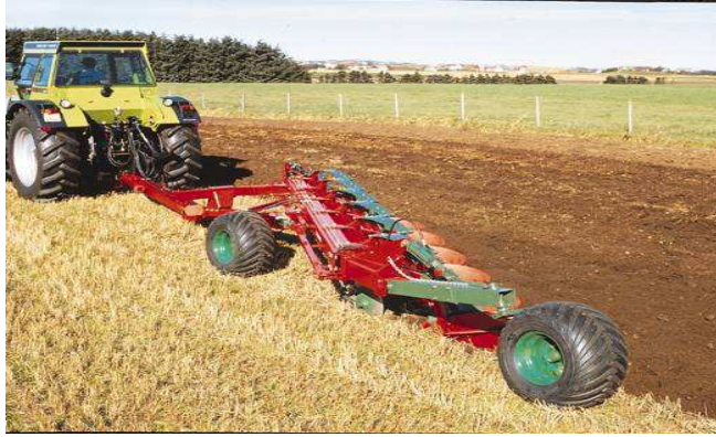
Fig. 16. Charrua de aivecas a enterrar restolho de cereal no solo
