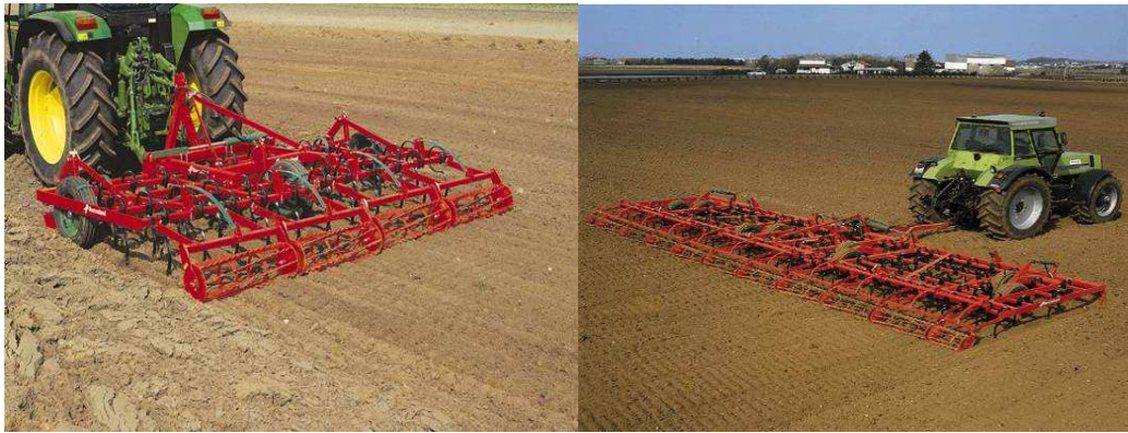
Fig. 13. Escarificador de braços flexíveis combinado com a grade rolante
