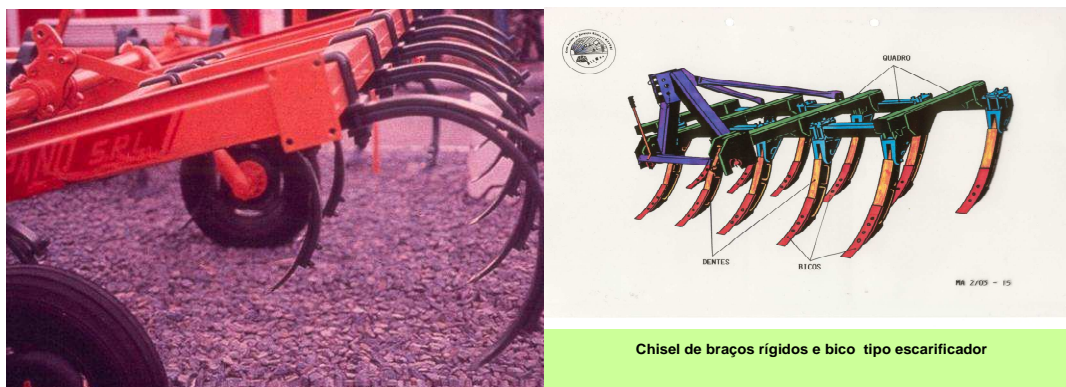
Fig. 4. Escarificador pesado “Chisel”
