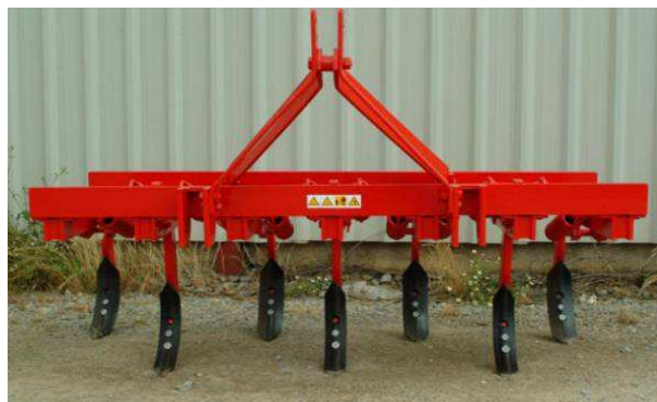
Fig. 3. Escarificador de braços rígidos com bicos “tipo escarificador”
