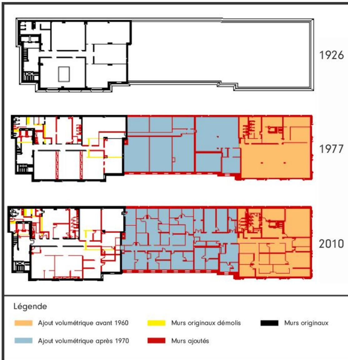
Image 34 : Monique Silva (éditions), *Plans du troisième étage avec les modifications réalisées entre 1926 et 2010*, dessins architecturaux fait en 2021. Basé sur le dessin cité dans le rapport réalisé en 2021 par le Ministério dos Transportes, Secretaria de Política Nacional de Transportes et Universidade Federal de Santa Catarina, «Revitalização do Patrimônio Histórico Ferroviário: Museu Ferroviário Nacional », p. 242.
