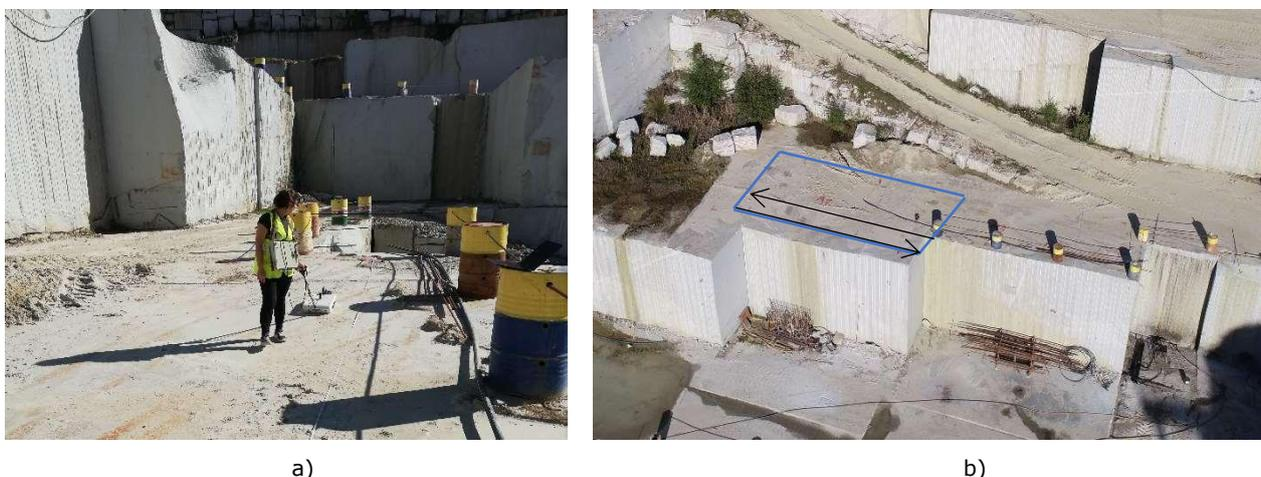
Figura 2 – a) Levantamento *in situ* com georadar e antena de 500 MHz, b) área de prospeção e orientação dos perfis de georadar.
