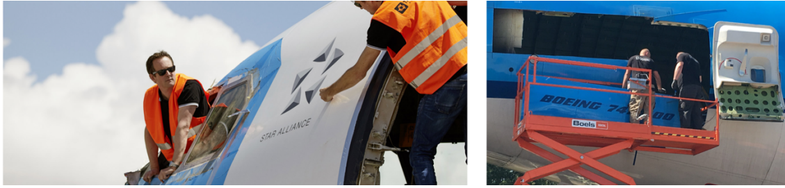
Figura 14 – Seleção de partes de aeronaves em desmantelamento para se obter fragmentos de alumínio da fuselagem (Fonte: aviationtag.com, 2020)
