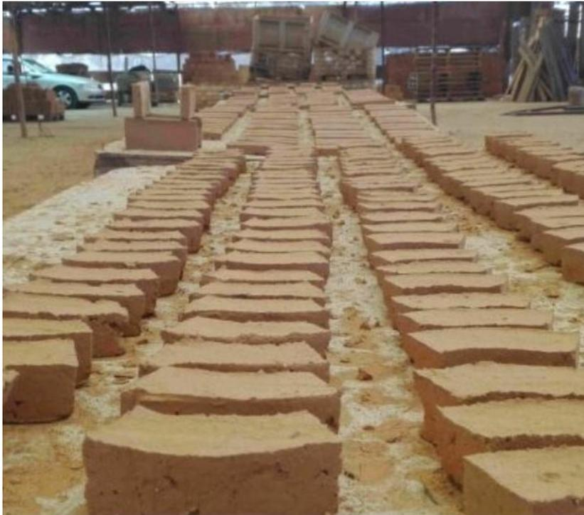
Image 18. le séchage de la brique par le soleil et l'air.
