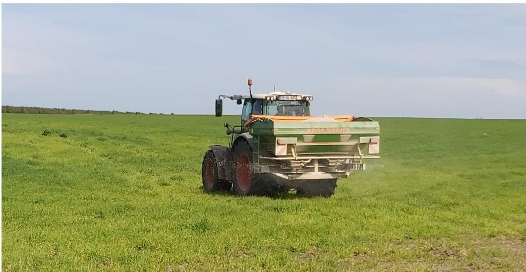
**Figura 8** - Distribuidor centrífugo de adubo com sistema VRT
