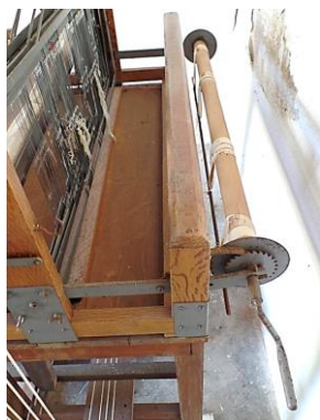
Fig. 22 - Órgão traseiro e freio do tear maior de Dulce Santana. Fonte: acervo da autora.
