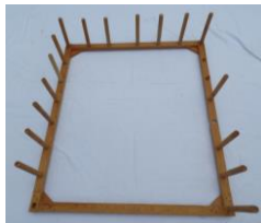
Fig. 13 - Augusto Santana - Urdideira quadro , anos 1950. Serrar, tornejar limar, brocar, pregar, a 109 x l 97cm. Pertença do atelier de Dulce Santana. Fonte: acervo de Maria Santana.
