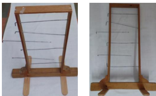
Figs. 8-9 - Augusto Santana - Suporte de 6 bobinas , visões de pé e deitado, anos 1950, 1960. Serrar, limar, brocar, pregar, a 65 x l 25cm. Pertença do atelier de Dulce Santana. Fonte: acervo de Maria Santana.
