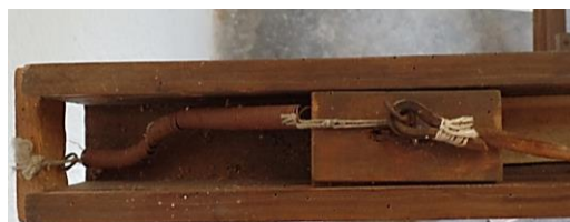
Fig. 23 - Sistema de lançadeira - mecanismo basculante percutor - do tear maior de Dulce Santana. Fonte: acervo da autora.
