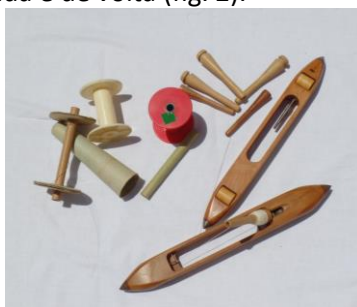
Fig. 2 - Lançadeiras rolantes, canelas e bobinas, anos 1950 e 1960. Fabrico industrial e artesanal, c 40 x l 4,5cm. Pertences do atelier de Dulce Santana. Fonte: acervo de Maria Santana.
