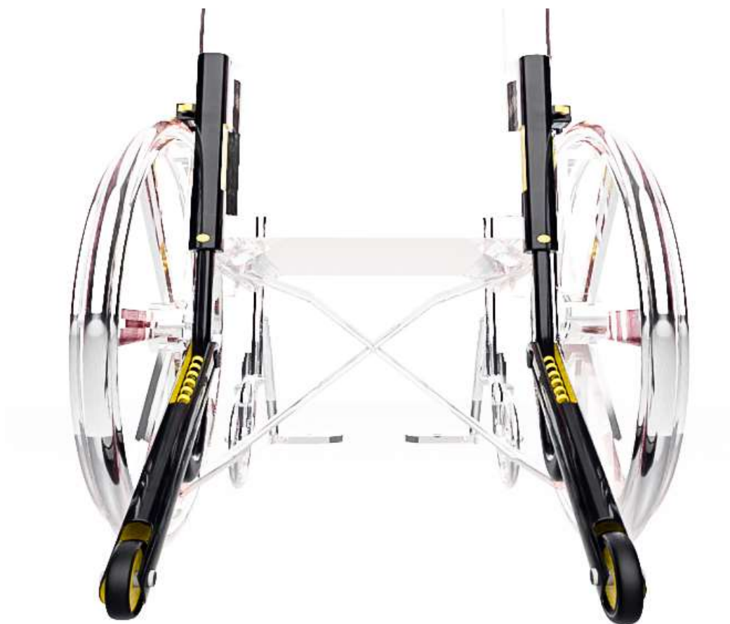
Figura 47 – Alternativa B - Estudo de Alternativa em Estrutura de Duas Partes
