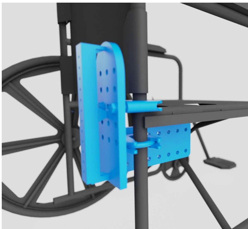
Figura 69 - Trava e Braçadeiras em azul no encaixe junto a Cadeira de Rodas
