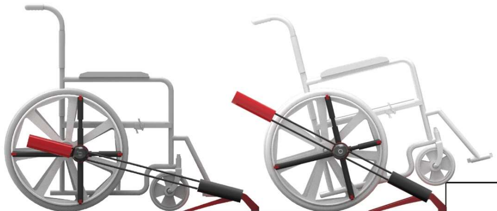
Figura 24 - Funcionamento Rampa Portátil
