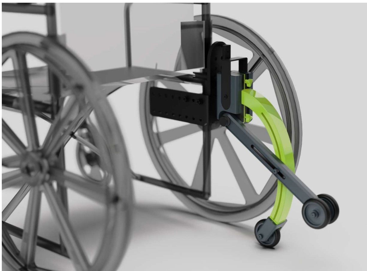
Figura 78 - O sistema completo acoplado a cadeira de rodas
