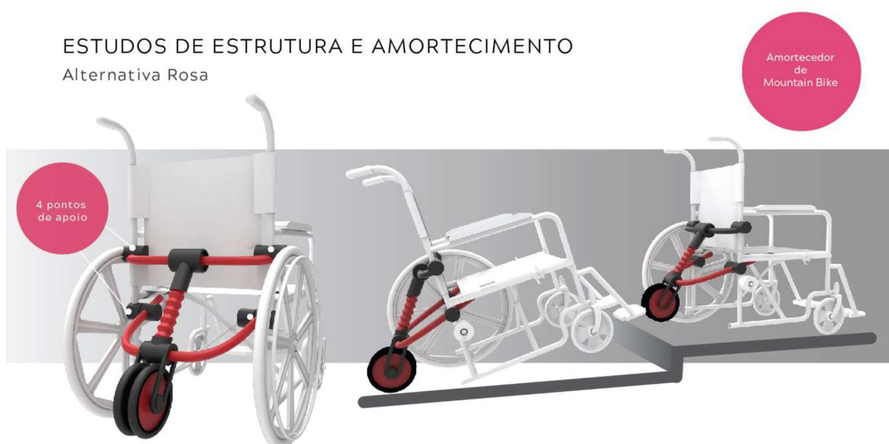
Figura 39 - Alternativa Amortecimento por Mola
