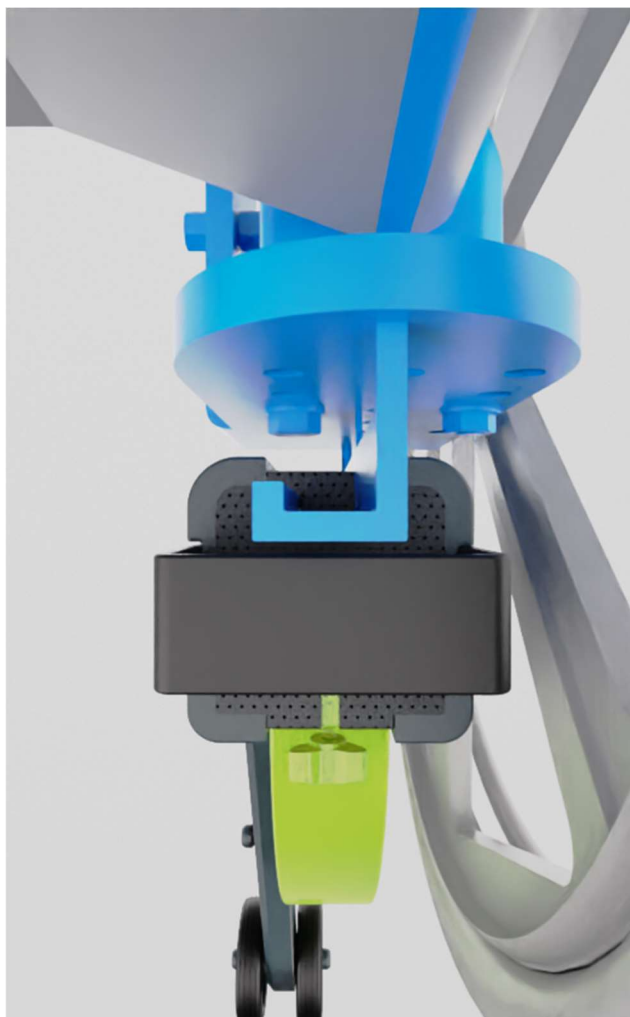
Figura 74 - Estrutura em L com o sistema completo encaixado
