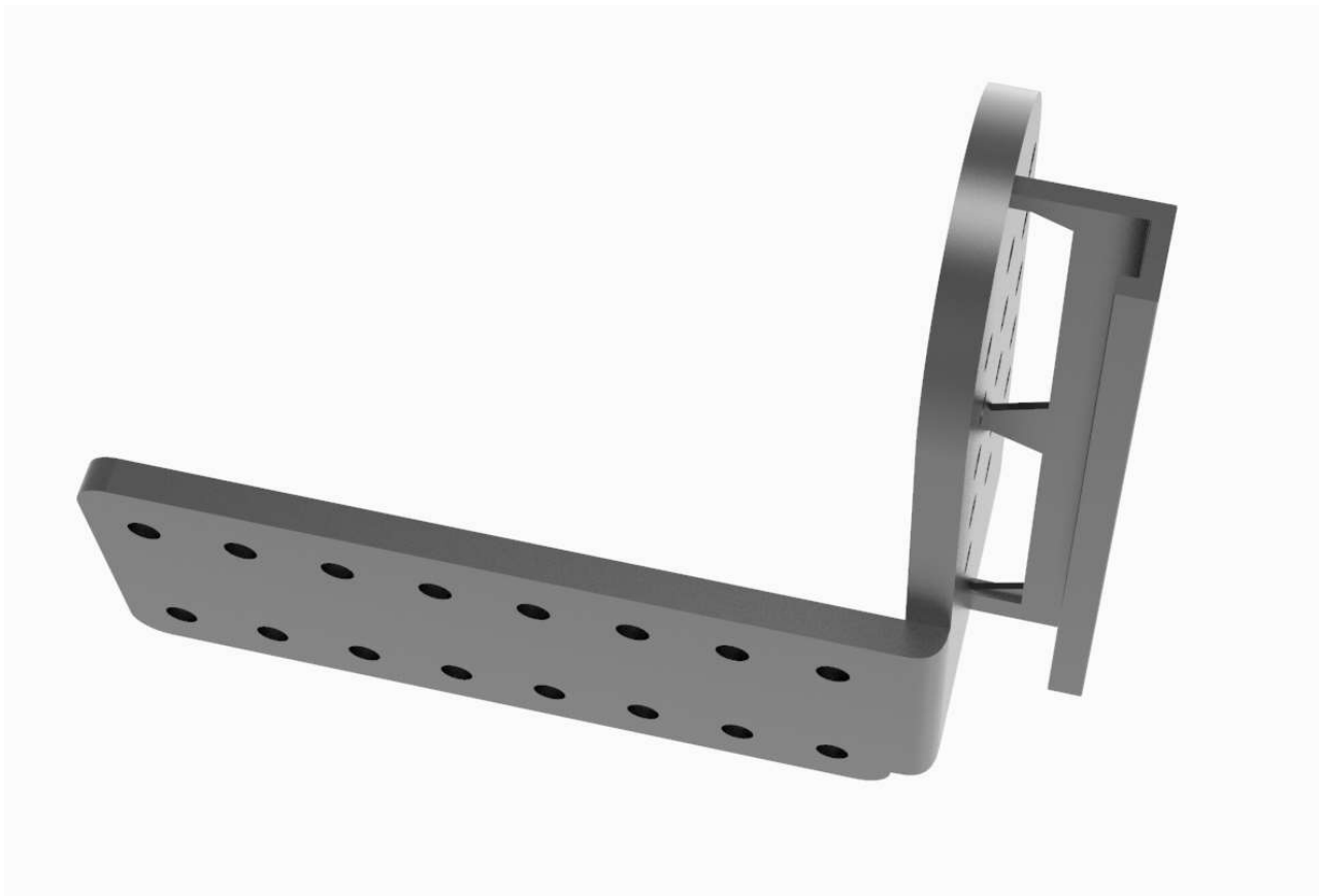
Figura 73 – Detalhe da Estrutura em L na Trava para encaixar a parte ativa do produto.
