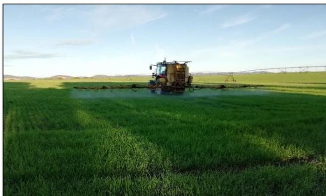
Figura 13: Controlo químico de infestantes com recurso a trator e pulverizador montado.
