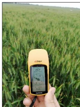
Figura 17: Dispositivo GARMIM eTrex H utilizado para marcação dos pontos no terreno.
