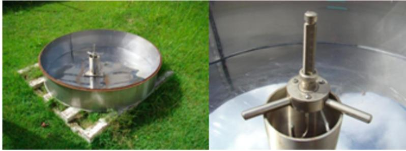
**Figura 5.1:** Tina evaporimétrica de classe A e pormenor do poço amortecedor com respetivo parafuso micrométrico.
