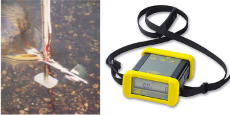
Figura 4.5: Molinete de hélice e contador de rotações.
