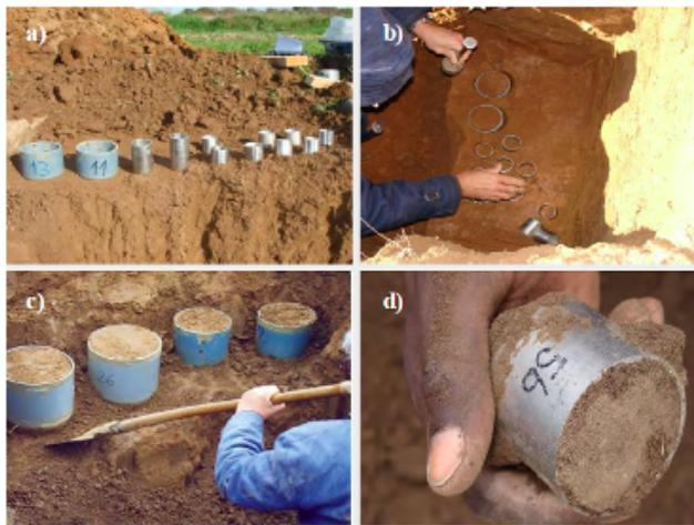
**Figura 6.18:** Colheita de amostras não perturbadas. (a) Exemplo de cilindros usados na colheita de amostras não perturbadas; (b) cilindros enterrados num horizonte/camada de solo; (c) processo de colheita das amostras de maior dimensão; e (d) amostra não perturbada (Ramos et al., 2016).
