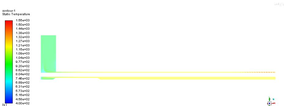
Figura 1. Campo de temperatura para o forno de aquecimento de bilhetes a operar com um excesso de ar de 1,8
