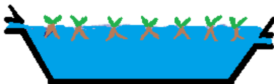
Figura 1.3 Sistema de macrófitas aquáticas flutuantes (adaptado de Dordio et al. , 2008).
