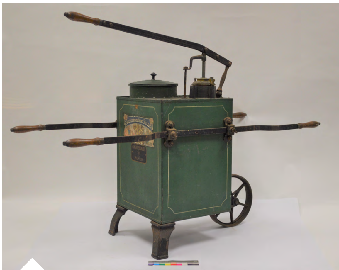
IMAGEM 3. Pulverizador para desinfeção por formaldeído, da casa F. & M. Lautenschlager (Alemanha), comprado para o Museu em 1907. Museu da Saúde, MS.00182
