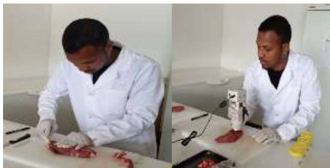
Figura 6. Processo de determinação da cor utilizando um colorímetro Minolta CR-400
