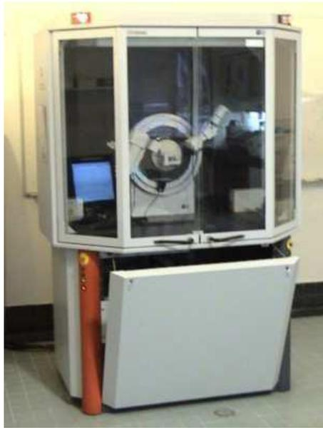
**Figura 2.16: Difractómetro de Raios-X Marca Bruker Modelo AXSD8 Advance.**
