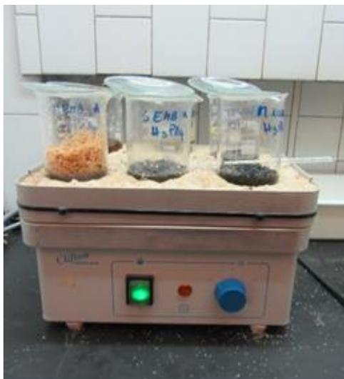
**Figura 2.10: Secagem dos precursores após impregnação em banho de areia.**
