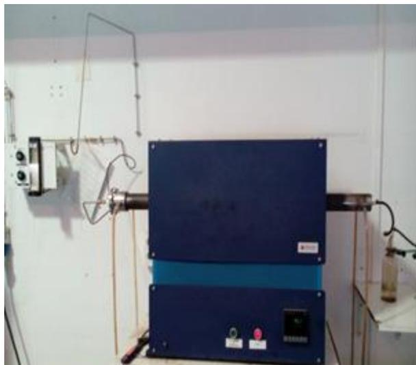
Figura 2.7: Forno Tubular utilizado na produção de carvões activados.
