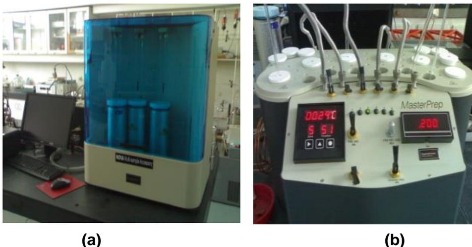
**Figura 2.15: Aparelho automatizado de análise volumétrica Quadratorb (a) e unidade de desgaseificação Master Prep Quadratorb da Quantachrome Instruments (b).**
