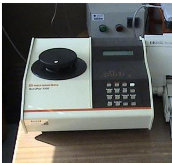
**Figura 2.14: Picnómetro de hélio da Micromeritics, modelo AccuPyc 1330.2.**
