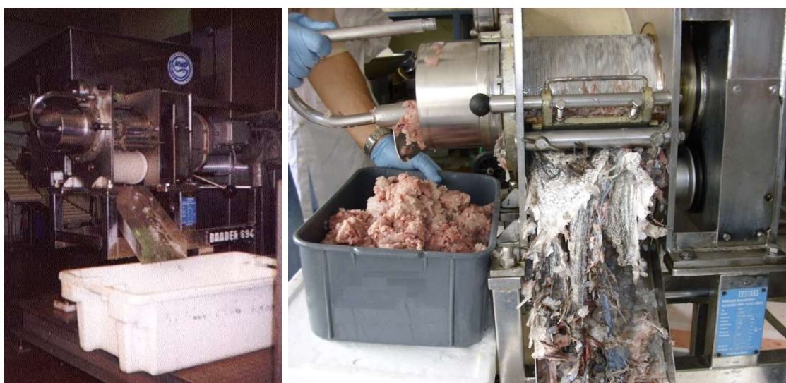
Figura 21. Separador mecânico BAADER 694 e separação da polpa da pele e espinhas.
