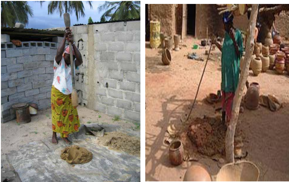
Figure 3 : Différentes façons d'homogénéiser les matières premières
