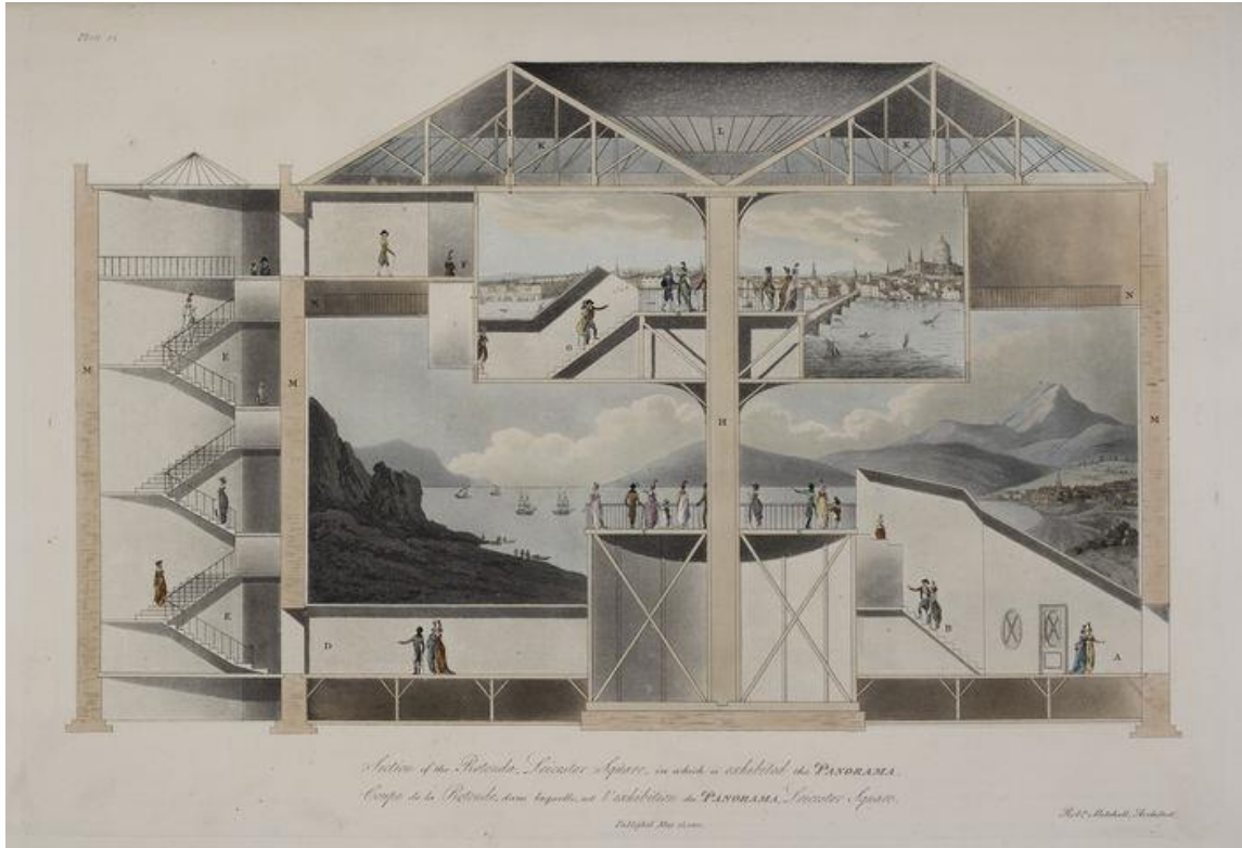
Figura 29: Sección transversal de la Rotonda Leicester Square: “Planos, y vistas en perspectiva ‘de Robert Mitchell 1801. (Mitchell fue el arquitecto responsable de la construcción de La Rotonda). Fuente: Aryse (2011). Recuperado de: La visión total: el Panorama
