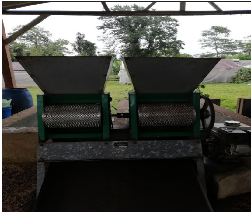
Figura 12- Máquina de Despolpa dos Grãos de Café Cereja
