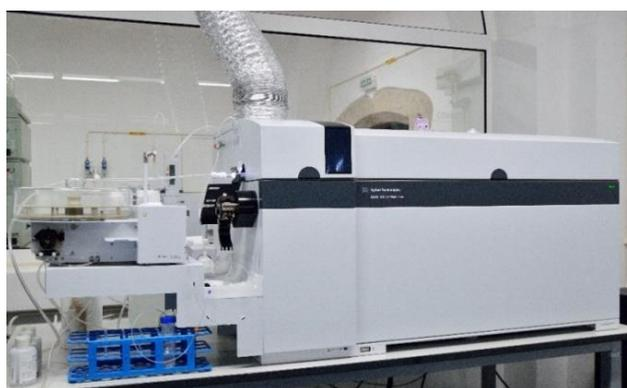
**Figura 5. 8** - Equipamento de ICP-MS Agilent 8800 Triple Quadrupole.
