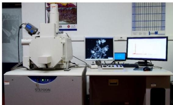
**Figura 5. 9** - Microscópio eletrónico de varrimento de pressão variável (HITACHI S-3700N) acoplado a um espectrómetro de energia dispersiva de raios-X (Bruker XFlash 5010 com detetor SDD acoplado), equipado com o *software* Esprit1.9.
