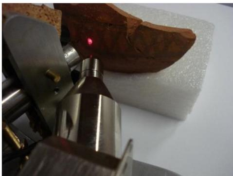
**Figura 5.7** - Equipamento portátil de fluorescência de raios-X da Amptek no decurso da análise de uma cerâmica decorada com pintura.
