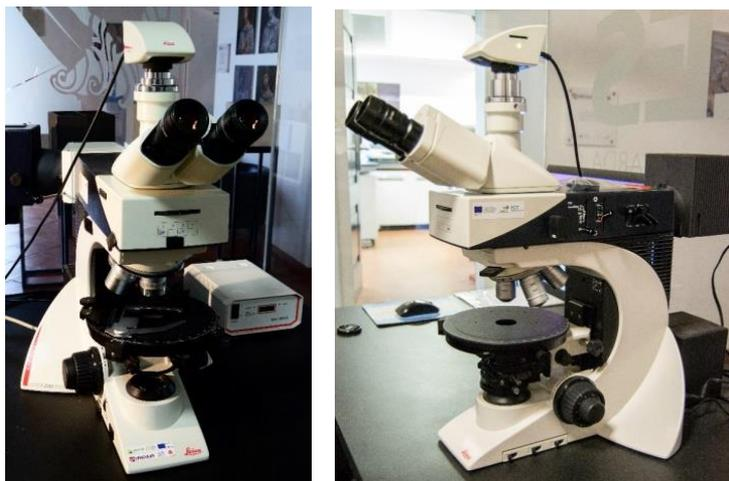
**Figura 5. 4** - Microscópio petrográfico (Leica DM2500M e DM2500 P).
