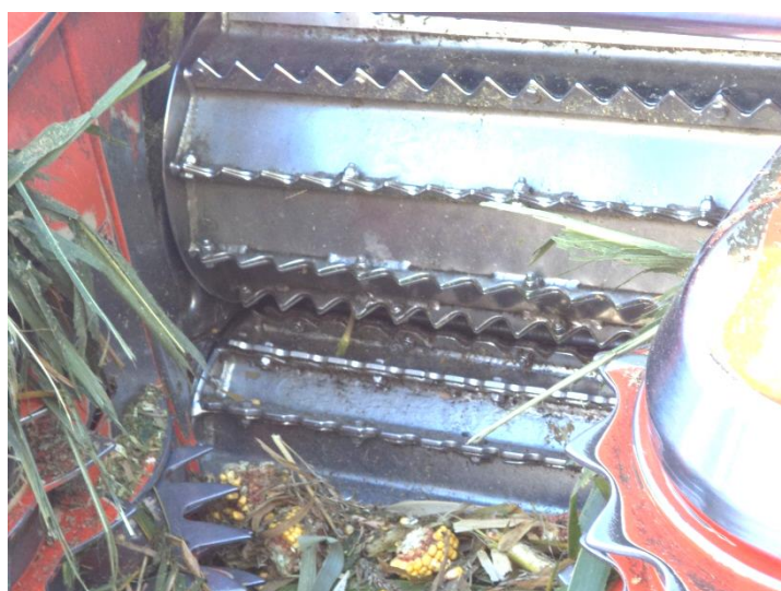
Tambores de alimentação de um colhedor de forragem Claas Jaguar 870. Herdade do Casão. TeAM, 2011
