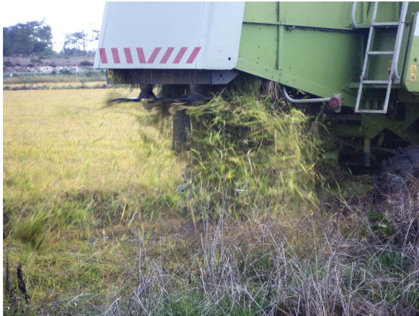
Espalhador de palha na ceifa de arroz. Herdade da Comporta – Visita de estudo 2013
