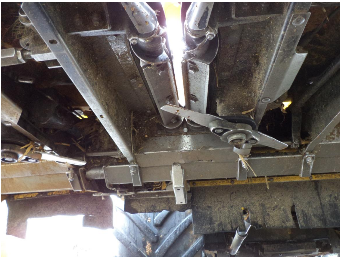
Vista inferior do mecanismo de colheita de uma linha de milho, sendo visível o rotor de facas para sectionar os caules.
