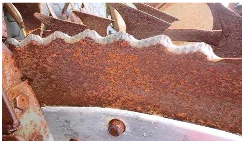
Rotor visto de baixo, mostrando o disco de corte
