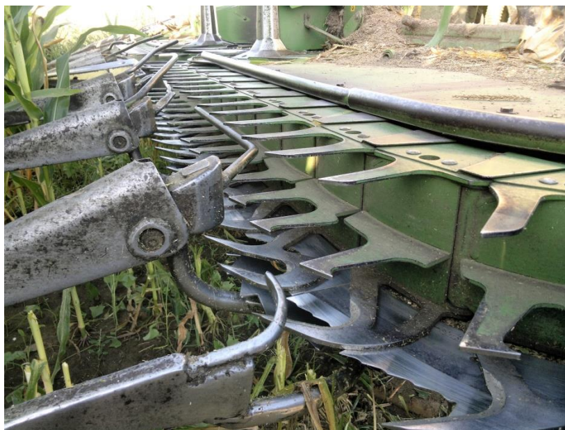
Correntes de transporte e corrente de facas, na base TeAM, 2018 – Herdade da Caravela do Campo
