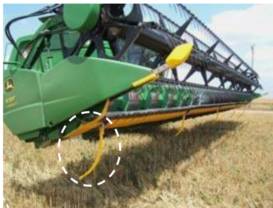
Apalpadores na parte inferior da mesa de corte
