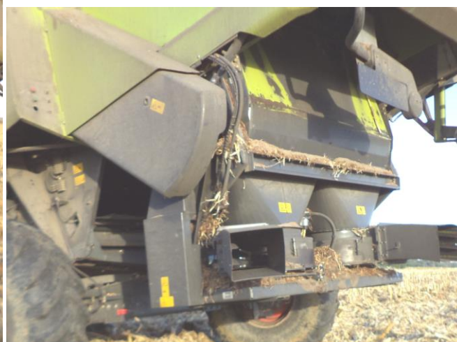
Conjunto de triturador de palha ( straw chopper ) e impulsores. Herdade do Monte-Novo – Visita de estudo 2016
