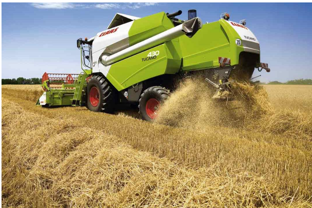
Palha encordoada e espalhamento lateral da moinha
