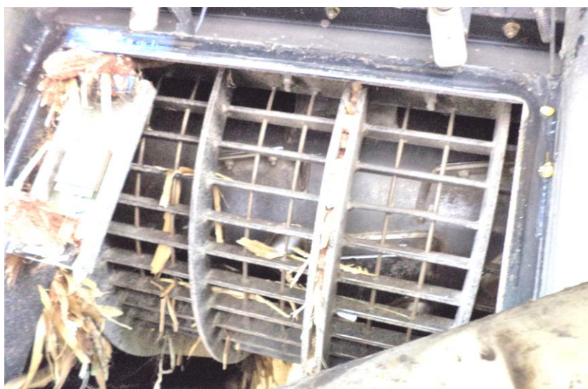
Grade de separação do sector de separação da CD, com rotor, New Holland CR 9.90
