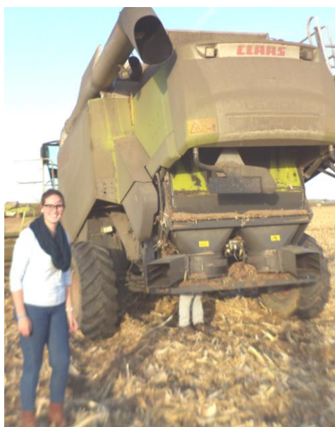
Conjunto de triturador de palha ( straw chopper ) e impulsores. Herdade do Monte-Novo – Visita de estudo 2016
