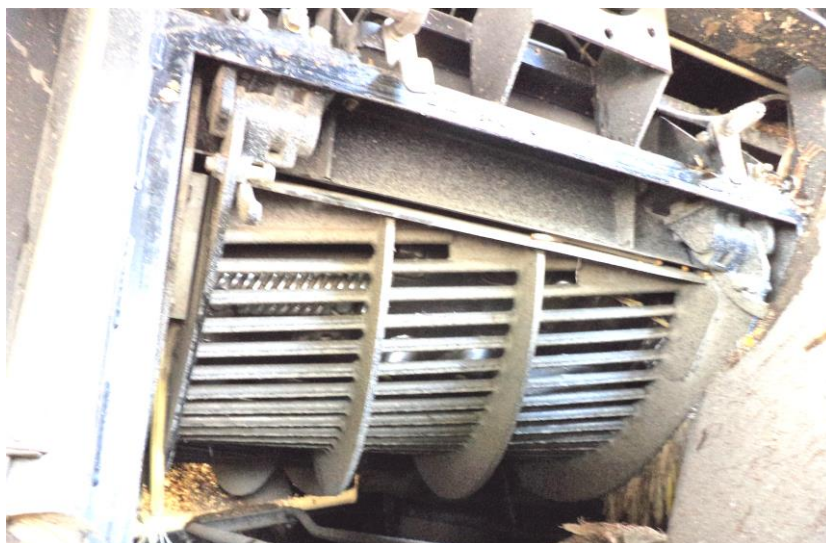
Contra-batedor do sector de debulha da CD, com rotor, New Holland CR 9.90
