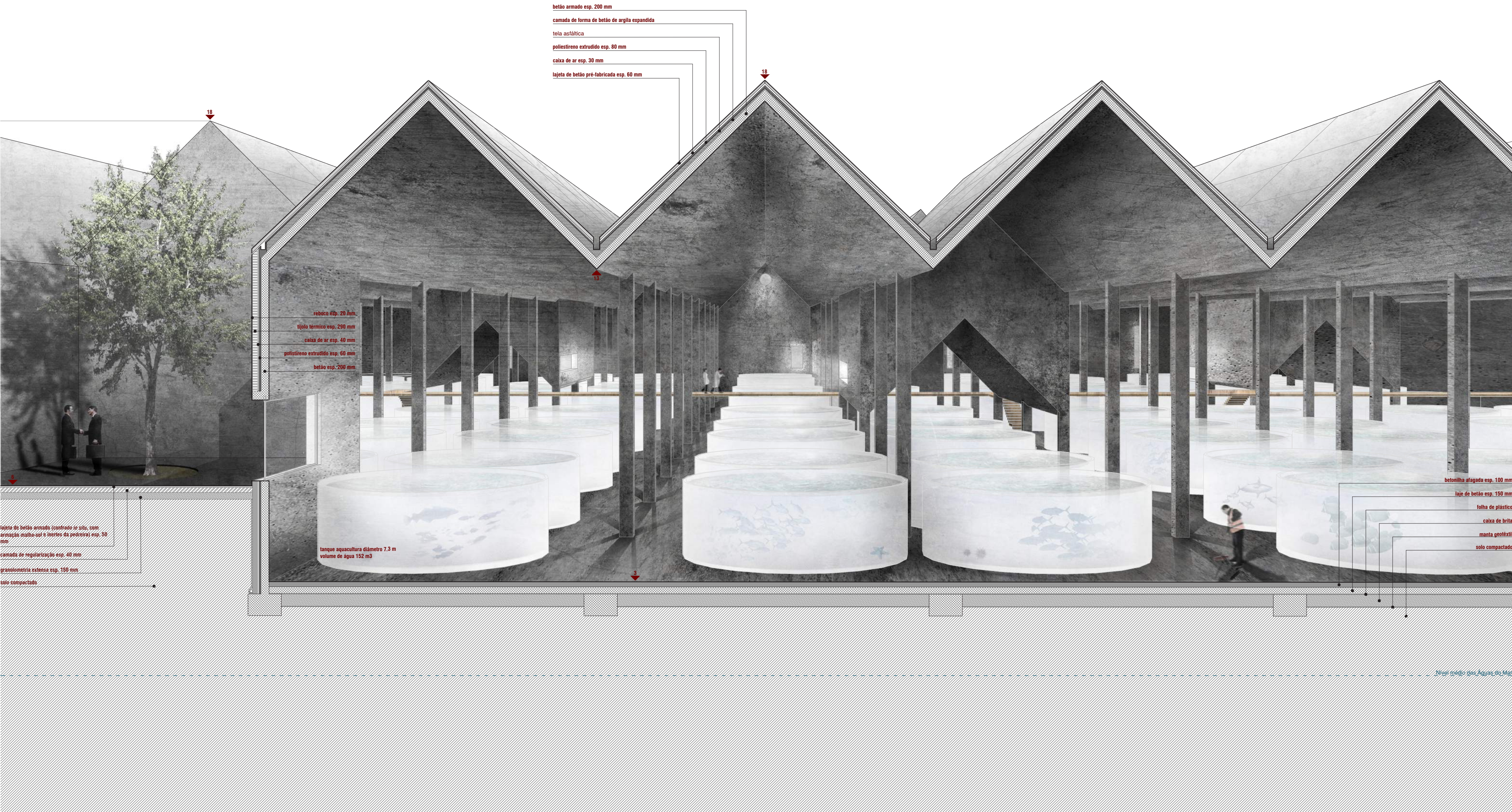
CORTE CONSTRUCTIVO GERAL AQUICULTURA ILUSTRADO (1º estudo)
