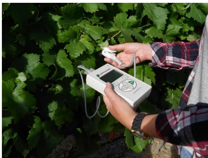
Figura 9 – Fotografia do procedimento de recolha dos valores de g_s .
