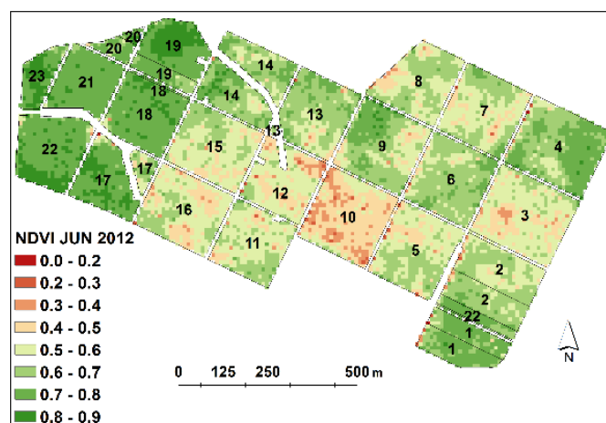
Figura 8 – Exemplo de um mapa que resultou do tratamento dos dados multiespectrais recorrendo à técnica IDW.
