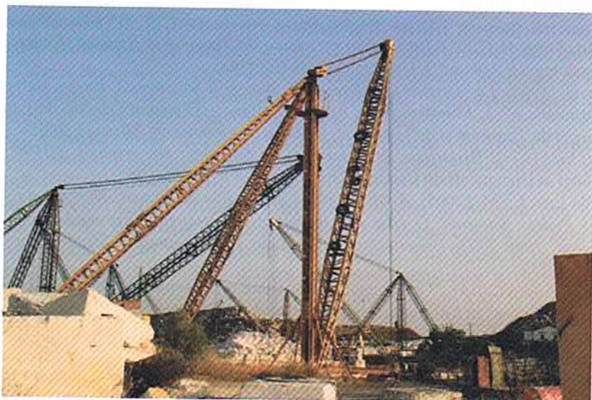
Fig. 12 – Várias guas (Derrick). Vila Viçosa, Pedreiras de S. Marcos. (Arquivo CECHAP – 2016.)
