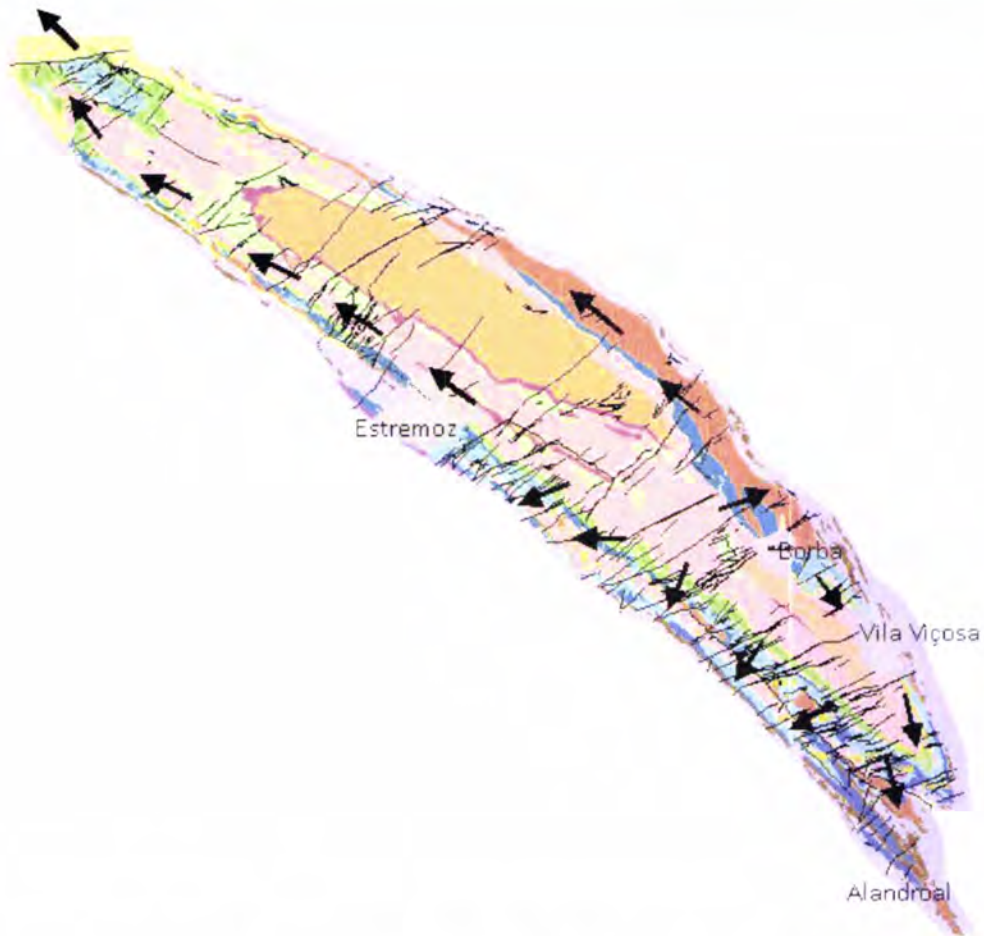
Figura 4.4: Representação esquemática das direcções preferenciais do sentido do fluxo de água subterrânea no anticlinal de Estremoz, S/ escala (Midões 1999 cit. in Midões e Costa, 2010)
