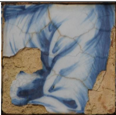
Linhas de craquelé com propagação vertical na chacota.
