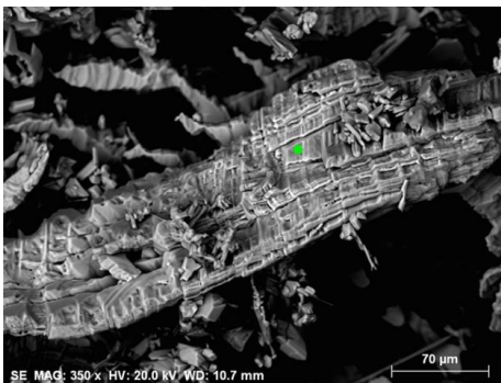
Análise pontual por EDS de um cristal
