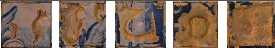
Padrão encontrado no destacamento de placas cerâmicas.
