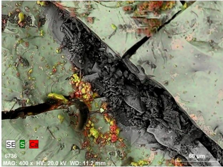
Mapa de análise elementar por EDS (S, Ca) numa área com craquelé.
