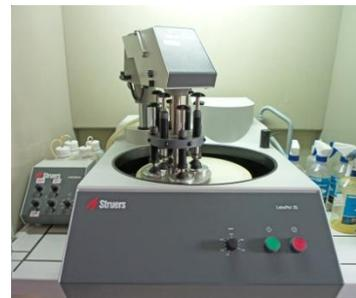
Figura 3.10: Polimentos mecânicos no equipamento LaboPol-35, Struers (LNEC) [Imagem: L. Esteves].
