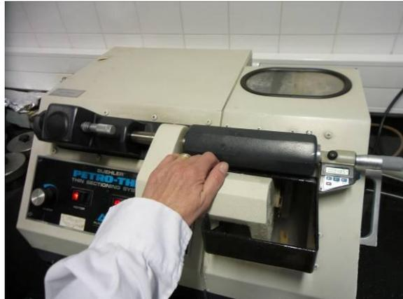
Figura 3.5: Corte e desbaste das amostras no equipamento Petro-Thin (LNEC) [Imagem: L. Esteves].
