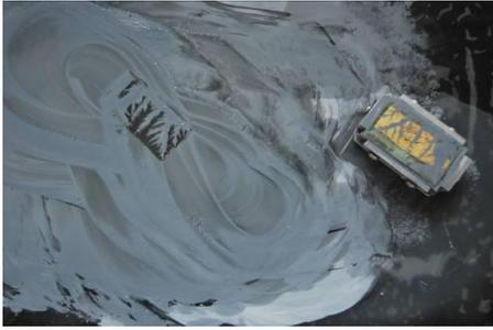
Figura 3.6: Desbaste manual com movimentos em “8” em pó abrasivo de 9  $\mu\text{m}$ , com a lâmina fixa num porta-amstras [Imagem: L. Esteves].
