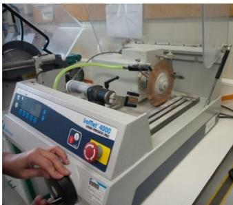
Figura 3.8: Corte fino em equipamento Logitech IsoMet 4000 (LNEC) [Imagem: L. Esteves].
