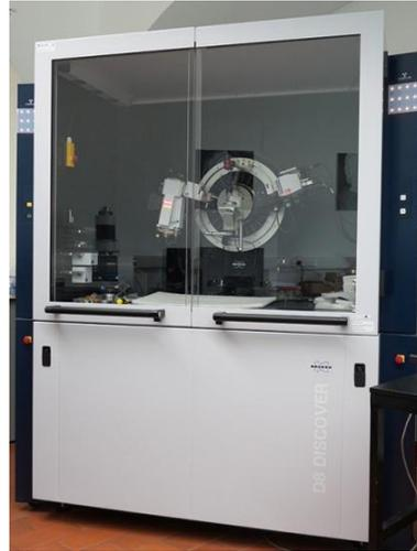
Figura 3.14: Difratómetro de raios-X Bruker AXS-D8 Discover (HERCULES) [Imagem: L. Esteves].
