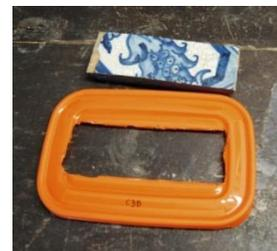
A evaporação preferencial na superfície exterior exposta (face vidrada e arestas originais), foi imposta através do isolamento do tardo com papel de alumínio e película de plástico, após o que a caixa foi fechada. A interposição do papel de alumínio destinava-se a evitar a contaminação do tardo por produtos resultantes da degradação a quente da película plástica. Designou-se este conjunto da caixa com o provete montado por “célula de envelhecimento” (Fig. 6.3).
