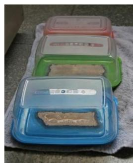
Figura 6.8: Sistema de proteção para evitar perda de água por evaporação [Imagem: L. Esteves].
