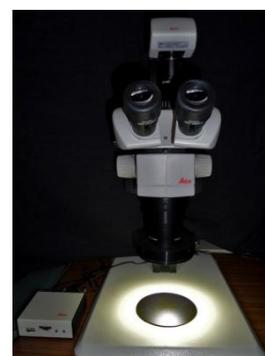
Figura 3.3: Lupa binocular Leica M80 com câmara incorporada (MNAz) [Imagem: L. Esteves].
