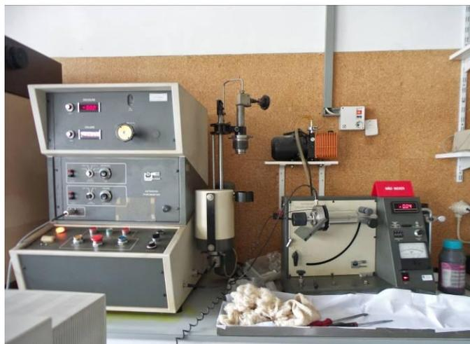
Figura 3.17: Porosímetro de mercúrio Quantachrome Autoscan (LNEC) [Imagem: L. Esteves].
