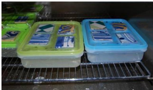
Figura 6.24: Células de envelhecimento no interior da estufa Heraeus a 60 °C (LNEC)
