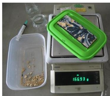
Figura 6.6: Pesagem do provete após o ciclo de secagem. A caixa serviu de recetáculo da matéria desprendida do tardez [Imagem: L. Esteves].
