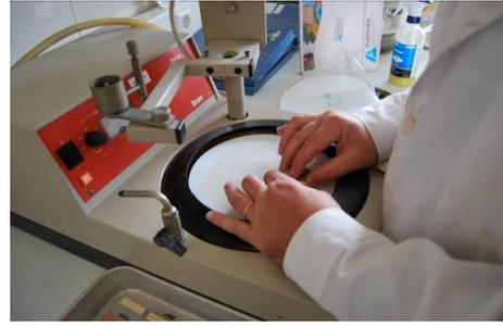
Figura 3.7: Polimento manual com panos e pulverizadores de pó de diamante no equipamento mecânico DAP-V, Struers (LNEC) [Imagem: L. Esteves].
