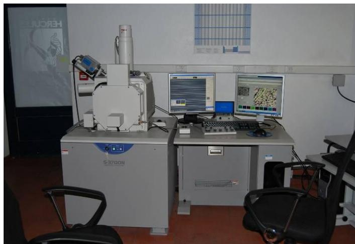
Figura 3.11: Equipamento HITACHI 3700N de análise MEV/EDX (HERCULES) [Imagem: L. Esteves].
