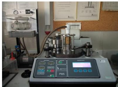
Figura 3.9: Primeiro polimento em equipamento Logitech PM5 (LNEC) [Imagem: L. Esteves].
