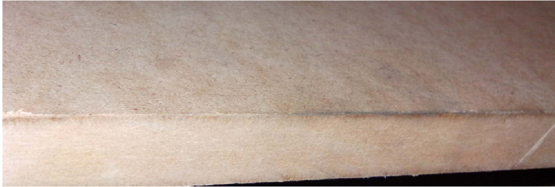
Figura 3 - Vista de corte lateral de uma placa de MDF
