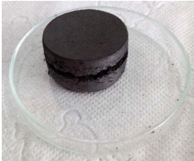
Figura 14 - Exemplo de uma peça de MDF com defeitos estruturais
