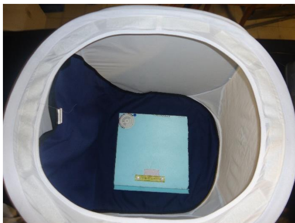
Figura 13: Detalhe dos materiais utilizados para recolha de fotografias utilizadas na análise morfológica, nomeadamente, a placa roofmate , no interior do cubo difusor.
