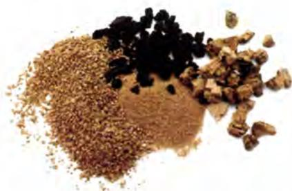
Figura 10- Imagem com diferentes tipos de granulado de cortiça.
