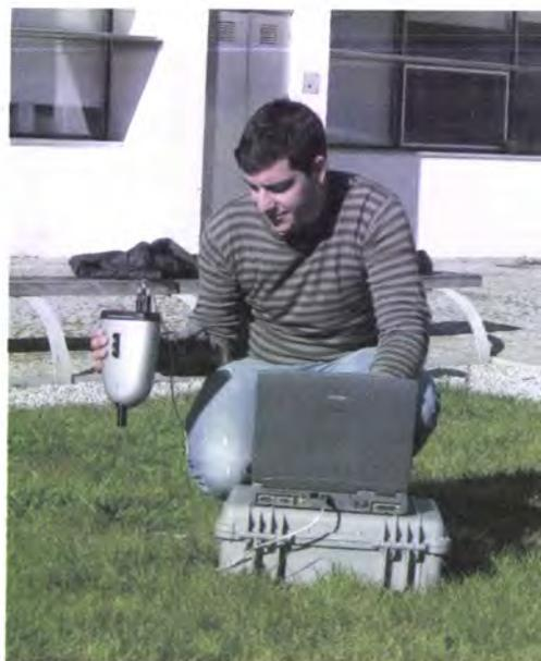
**Figura 3.2:** Espectrorradiómetro portátil FieldSpec® HadHeld.
