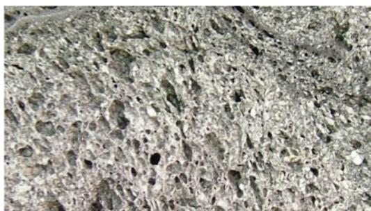
**Figura 20** – Terraço artificial de Cerro das Alminhas 1 (Bronze Final) e grauvaques com alteração térmica («vitrificação») do mesmo, de textura vesicular (imagem de lâmina delgada).
