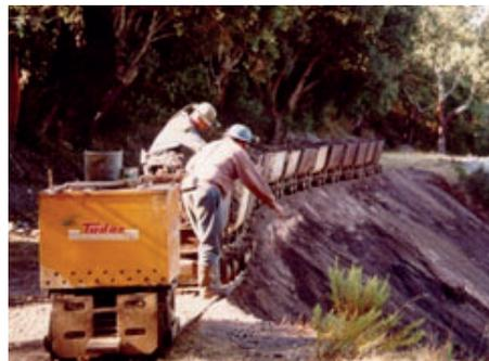
**Figura 17.** Mina da Serra do Rosalgar em 2000, escritórios da Empresa Mineira da Serra do Cercal e locomotiva elétrica movida a bateria (Matos e Rosa, 2001). Após a sua extração em câmaras com apoio de pilares, o minério extraído percorria a galeria longitudinal em vagonetas até um pequeno aterro. Após uma breve seleção era transportado por camiões até aos equipamentos com crivos, localizados junto aos escritórios da empresa.
