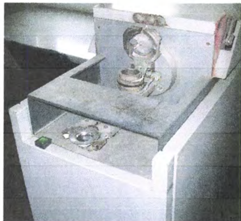
Figura II.2: Peroladora, utilizada com a finalidade de fazer pérolas a utilizar na análise química.
