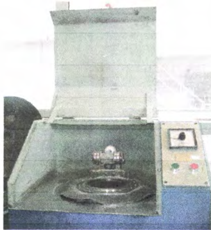
Figura II.1: Moinho de anéis, utilizado para moer matérias que necessitam uma granulometria específica para a realização de certos ensaios.
