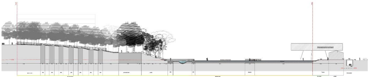
69. Modelação para alcançar a cota de 47m. Plano de água e edifício miradouro. Fonte: AJO, 2010
